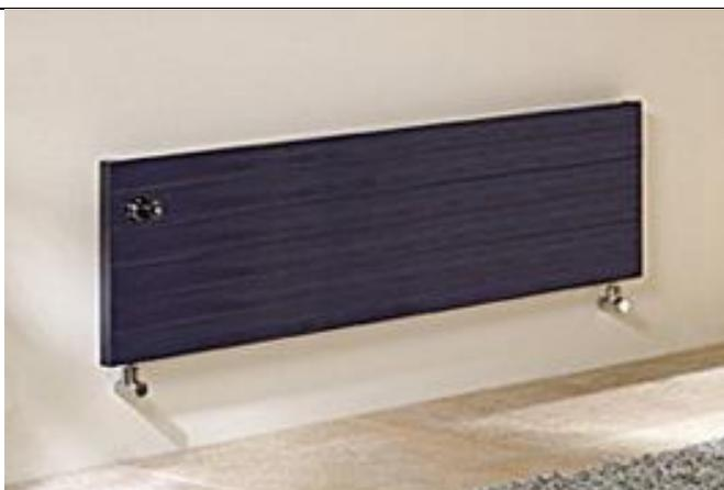
Sono piastre saldate tra loro al cui interno si trova il fluido termovettore. Lo scambio di calore avviene in piccola parte per convezione ed in quantità consistente per irraggiamento. Funziona temperature più basse rispetto ai termosifoni ottenendo un risparmio energetico e una diffusione omogenea della temperatura nella stanza
