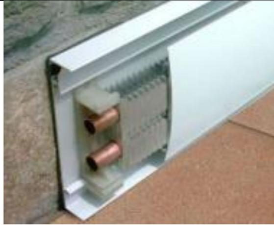
Il sistema radiante (di dimensioni di circa 15 centimetri in altezza per 3 in larghezza) è posizionato lungo il perimetro delle stanze (in particolare lungo le pareti esterne) in sostituzione ai normali battiscopa. Il calore passa dal sistema e si distribuisce sulle pareti con duplice effetto: riscalda le superfici interne dei muri che a loro volta irradiano calore all'interno della stanza e tengono asciutti i muri dall'eventuale possibile presenza di umidità.
