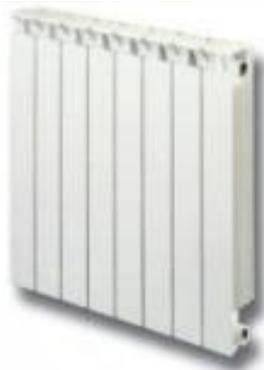
Scaldano l'ambiente grazie al fluido scaldante che, proveniente dalla caldaia, cede calore all'ambiente attraverso le pareti dei radiatori stessi. La temperatura normale di esercizio prevede l'ingresso dell'acqua (dall'alto) a 60-80°C e una differenza in uscita di 10°C. Lo scambio di calore avviene in piccola parte per irraggiamento (30%) ed in quantità consistente per convezione (70%). Quelli in alluminio hanno un costo contenuto, sono leggeri e caratterizzati da una bassissima inerzia termica.
